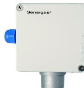
Alimentazione 11...14Vdc. Elemento sensibile Catalitico (vers. S), Pellistor (vers. P) o Semiconduttore (vers. T) per gas infiammabili, e cella elettrochimica (vers. S o P) o Semiconduttore (vers. T) per gas tossici. Fino a tre soglie di intervento. Led sulla custodia per l'indicazione dello stato di funzionamento. Conteggio automatico del tempo di vita dei sensori.
