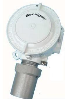
Alimentazione 11...14Vdc. Elemento sensibile Catalitico (vers. S), Pellistor (vers. P) o Semiconduttore (vers. T) per gas infiammabili, e cella elettrochimica (vers. S o P) o Semiconduttore (vers. T) per gas tossici. Fino a tre soglie di intervento. Led sull'elemento sensibile per l'indicazione dello stato di funzionamento. Conteggio automatico del tempo di vita dei sensori.
