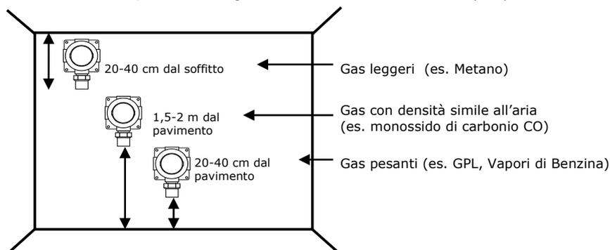
Il posizionamento delle sonde deve tenere conto, oltre che alle già citate regole di carattere generale, anche delle seguenti regole di installazione.
