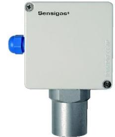
Alimentazione 11÷28Vdc. Elemento sensibile Catalitico (vers. S), Pellistor (vers. P) o Semiconduttore (vers. T) per gas infiammabili, e cella elettrochimica (vers. S o P) o Semiconduttore (vers. T) per gas tossici. Fino a tre soglie di intervento. Led sull'elemento sensibile per l'indicazione dello stato di funzionamento. Conteggio automatico del tempo di vita dei sensori.
