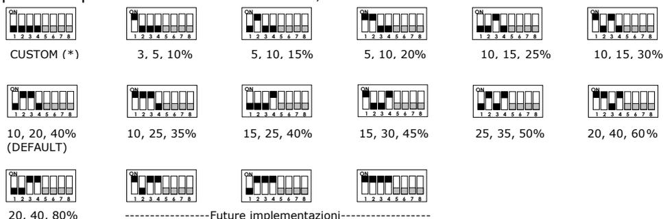
(\*) Quando i primi quattro selettori del dip-switch sono in posizione OFF, le soglie di intervento risultano impostabili solo a mezzo del terminale di servizio e manutenzione **TUS40**.
