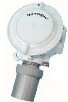
Alimentazione 11÷28Vdc. Elemento sensibile Catalitico (vers. S), Pellistor (vers. P) o Semiconduttore (vers. T) per gas infiammabili, e cella elettrochimica (vers. S o P) o Semiconduttore (vers. T) per gas tossici. Fino a tre soglie di intervento. Led sull'elemento sensibile per l'indicazione dello stato di funzionamento. Conteggio automatico del tempo di vita dei sensori.
