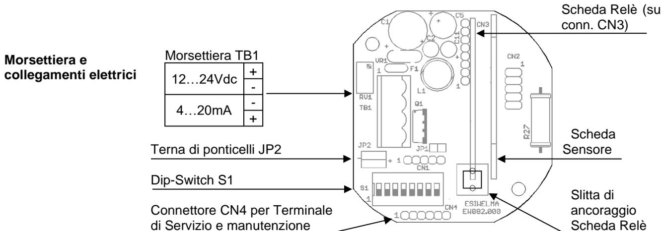
**Cablaggi:** Utilizzare, in funzione della distanza dei collegamenti, cavo ad almeno 3 conduttori di sez. minima 0,75mm<sup>2</sup> fino 100m, 1mm<sup>2</sup> fino 200m, 1,5mm<sup>2</sup> fino 500m. In presenza di disturbi di natura elettromagnetica utilizzare cavo schermato. Se presente la scheda a relè utilizzare cavo multipolare adatto al n° di connessioni. La guaina del cavo non deve superare il diametro previsto dal pressacavo.
