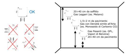
Il posizionamento delle sonde deve tenere conto, oltre che alle già citate regole di carattere generale, anche delle seguenti regole di installazione; ovvero le sonde devono essere installate:
