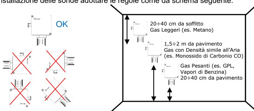
Il posizionamento delle sonde deve tenere conto, oltre che alle già citate regole di carattere generale, anche delle seguenti regole di installazione; ovvero le sonde devono essere installate:
