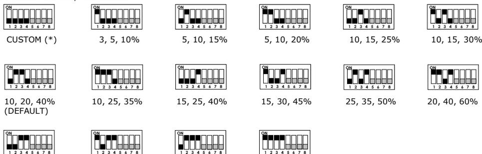
(\* Quando i primi quattro selettori del dip-switch sono in posizione OFF, le soglie di intervento risultano impostabili solo a mezzo del terminale di servizio e manutenzione **TUS40..** o attraverso Display (Scheda DR... o DN...).
