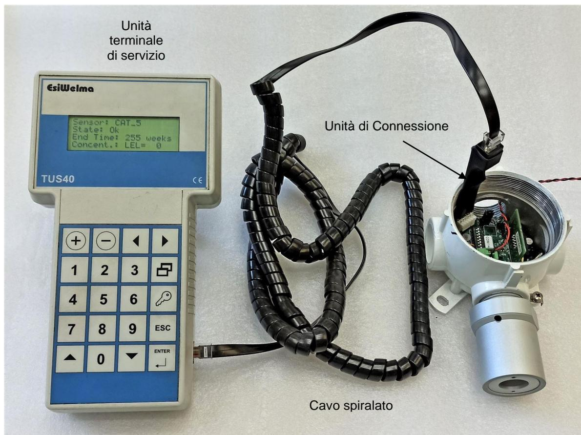
Fig. 2.1 – Kit Terminale per il monitoraggio e la programmazione dei sensori UR.21/41..
