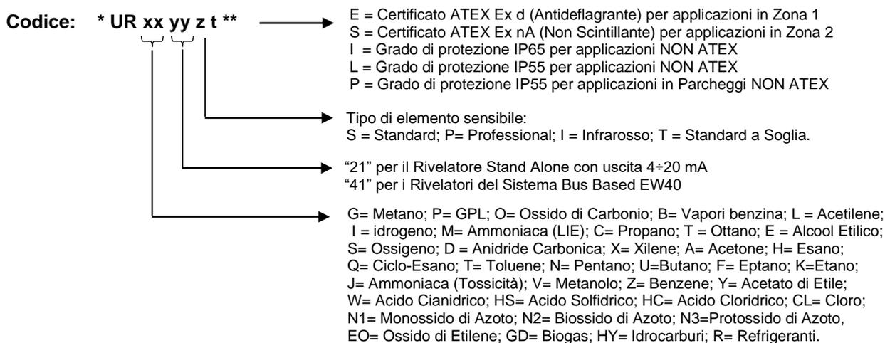
\* Prefisso al nome del Rivelatore: DR = Display con Relè; DN = Display senza Relè (solo per UR.21/41..)
