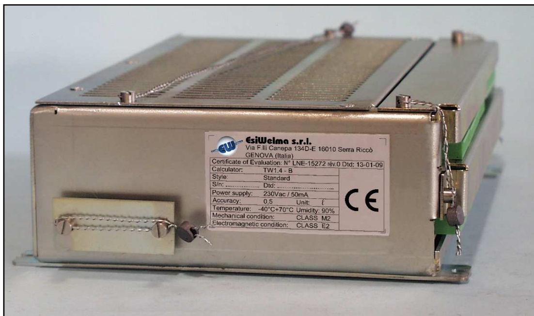
Photo 8: Targa di identificazione Testata elettronica TW1.4-B
