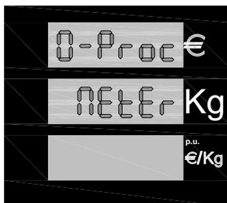
Questa operazione va effettuata almeno alla prima installazione sul punto vendita. Quando tutti i parametri sono stati inseriti e, la testata è pronta ad erogare, si può settare il parametro **MC**. La testata ordina al misuratore l'azzeramento, ed appena terminata la procedura si ridispone automaticamente pronta per erogare. Se durante questa operazione dovesse mancare la tensione di rete, il parametro viene azzerato. All'accensione se necessario, la procedura deve essere nuovamente avviata.
